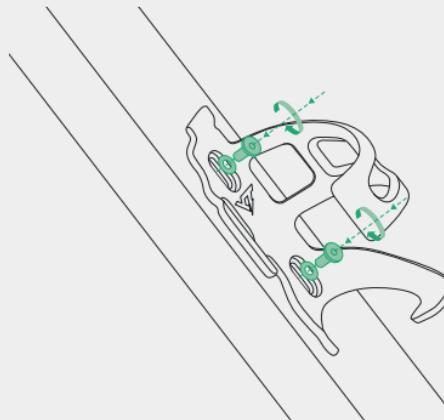
**1.3** Setze die Schrauben ein und drehe sie mit einem Inbus (3 mm) im Uhrzeigersinn fest (2 Nm). Benutze dabei unbedingt die Unterlegscheiben.
