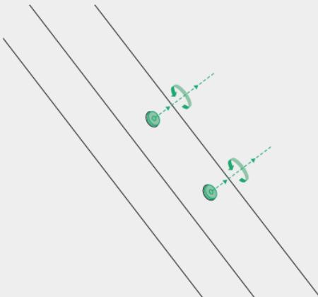
**1.1** Drehe die Schrauben mit einem Inbus (3 mm) gegen den Uhrzeigersinn heraus und lege sie beiseite, du brauchst sie nicht mehr.
